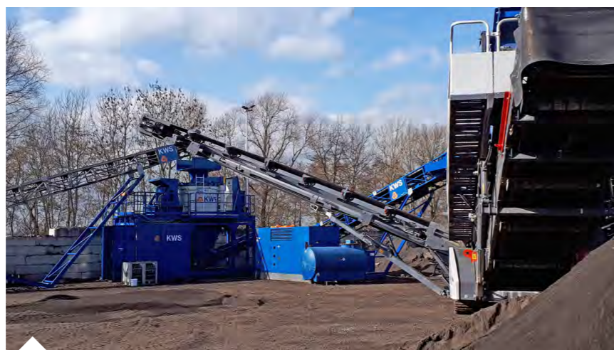
De nieuwe asfalscheider van KWS. Deze scheider kan asfaltgranulaat dat vrijkomt bij wegwerkzaamheden splitsen in vrijwel kale steen en zand en vulstof. Met deze hightech oplossing wordt het aantal mogelijkheden voor asfaltrecycling uitgebreid.
