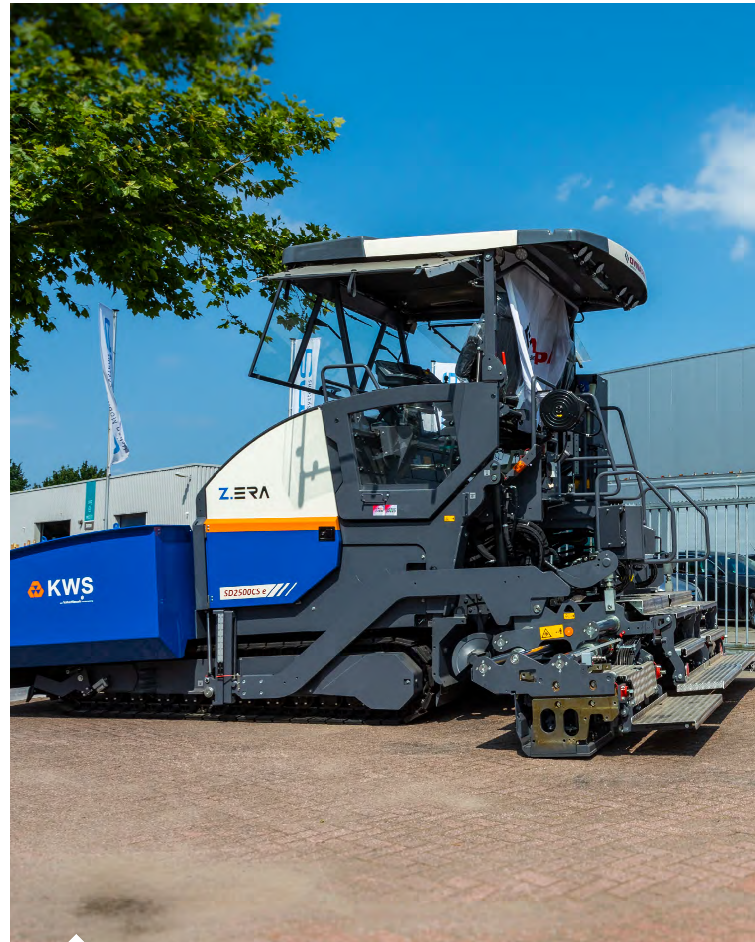
Volledig elektrische asfaltspreidmachine.
