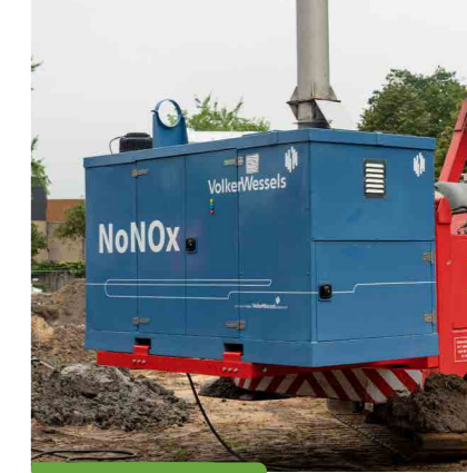
Het NoNOx filter reduceert 99% van de stikstofuitstoot van zowel stilstaand als mobiel materieel.
